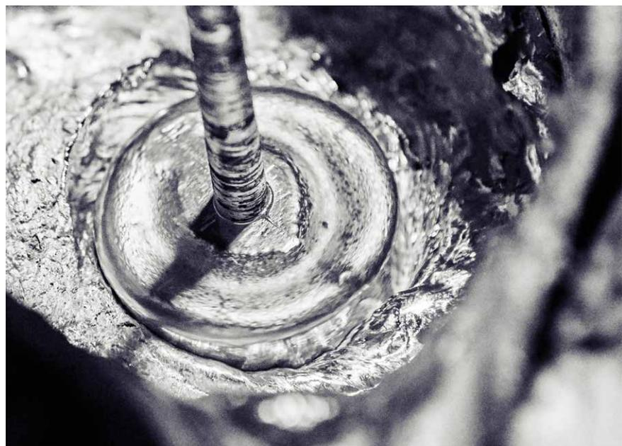
**Bild 2:** Herstellung der halbfesten Schmelze in einer Pfanne.
