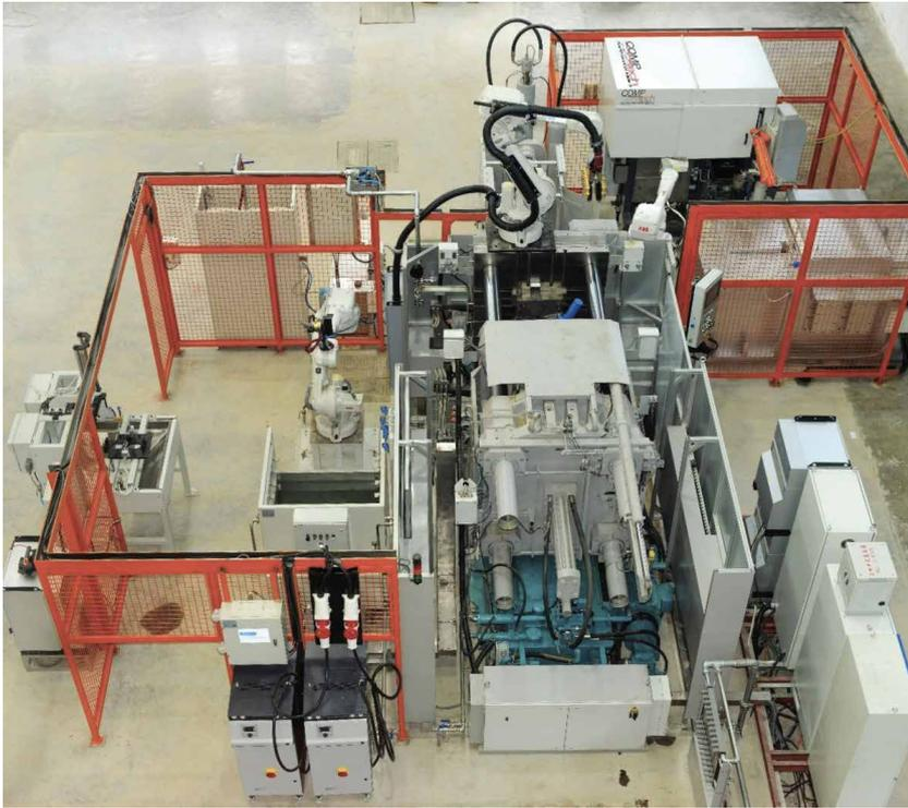
**Bild 3:** Die Anordnung der Schmelzherstellung innerhalb der Prozessanlagen einer Gießzelle. Das Schmelzaggregat befindet sich oben rechts im Bild.
